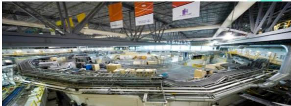
Accélérateur de particules dans lequel le champ magnétique, créé par une suite circulaire d'aimants, augmente durant le cycle d'accélération de telle façon que les particules circulent sur une orbite de rayon fixé
